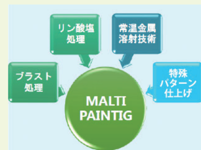
図・1 重量鉄骨を対象にした塗装技術の総合的活用
