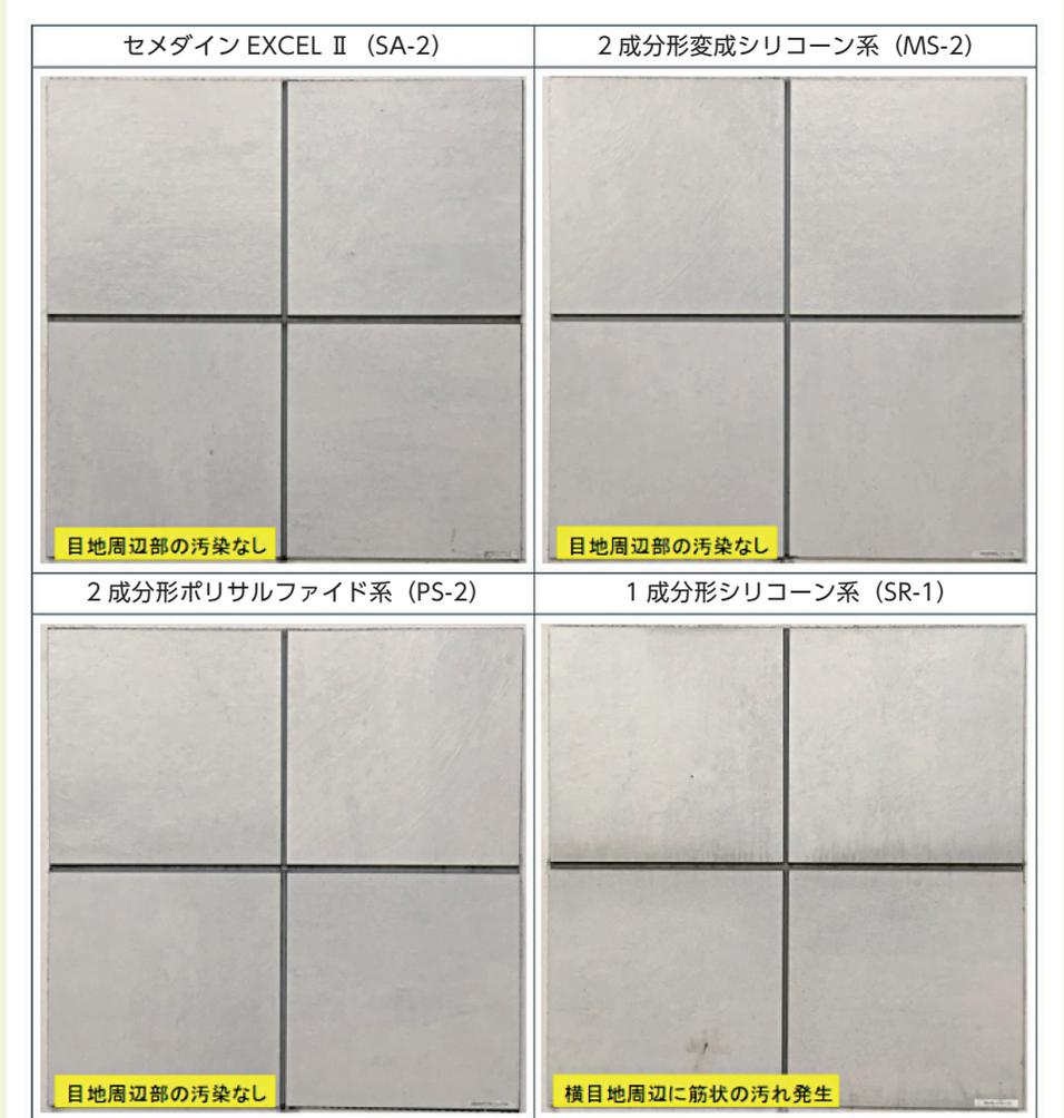
写真・7 シーリング材周辺の汚染確認 シリコン系では目地周辺部に筋状の汚れが発生しているのに対し、EXCELⅡでは良好な状態が維持されています。
